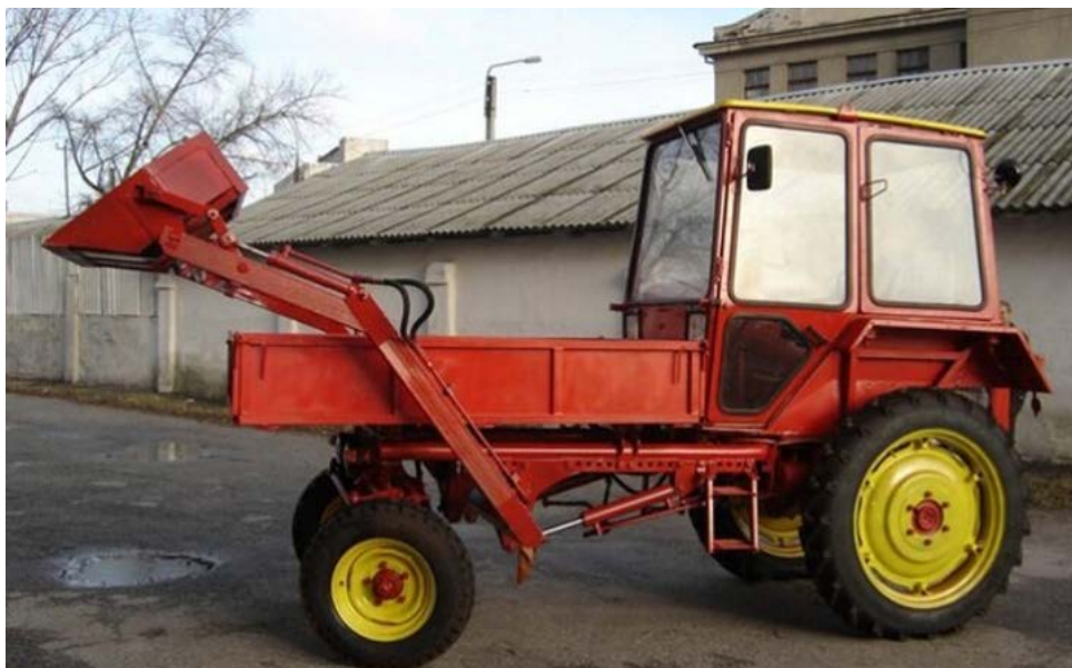
Рисунок 1.13 – Общий вид универсального самопогрузчика СУ-Ф-0,4 на базе самоходного шасси Т-16
