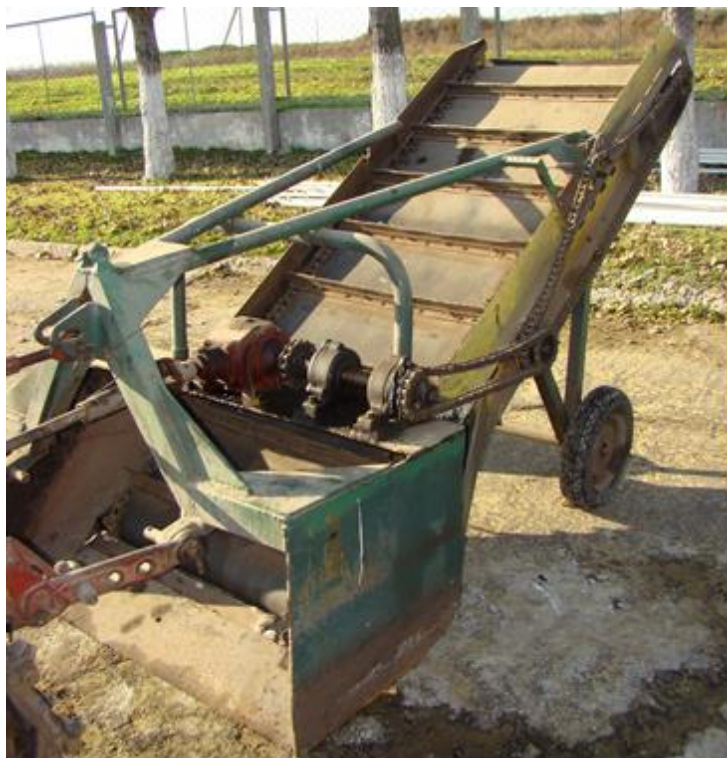
Рисунок. 3.3 - Общий вид навесной машины для удаления и погрузки почвы
