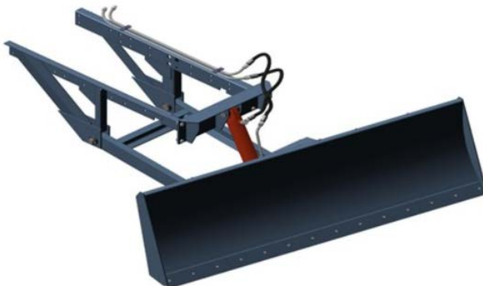
Рисунок 1.7 – Общий вид бульдозерной навески БН-1
