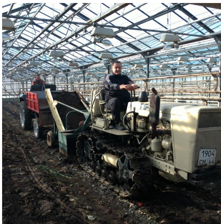
Рисунок 4.1 – Экспериментальный образец навесной машины по удалению и погрузке почвы из теплиц
