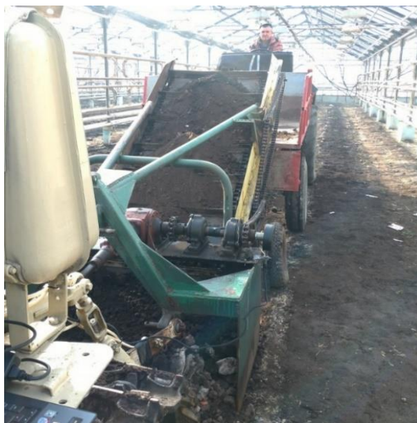
Рисунок 3.7 - Навесная машина для удаления и погрузки почвы в теплицах в работе
