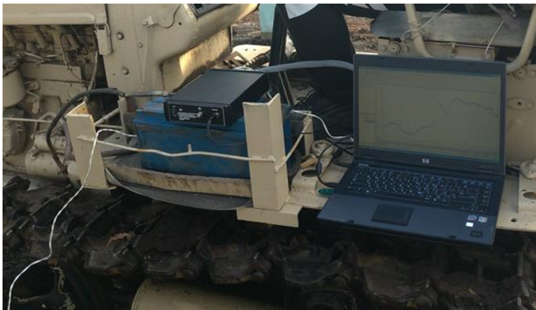
Рисунок 3.6 - Комплекс МИГ-018 для измерения тягового усилия и крутящего момента
