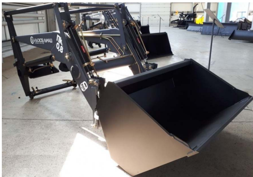
Рисунок 1.10 – Общий вид ковшового погрузчик ПКУ-0,8
